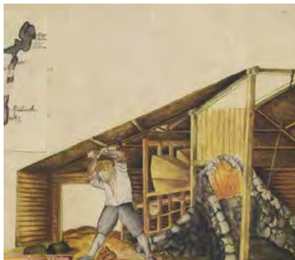
Fig 6 Kopparhytta enligt Raines gruvkarta 1683. Till höger den låga suluugn med sina lädliknande bälgar och smältaren i färd med att slå sönder malmen.
