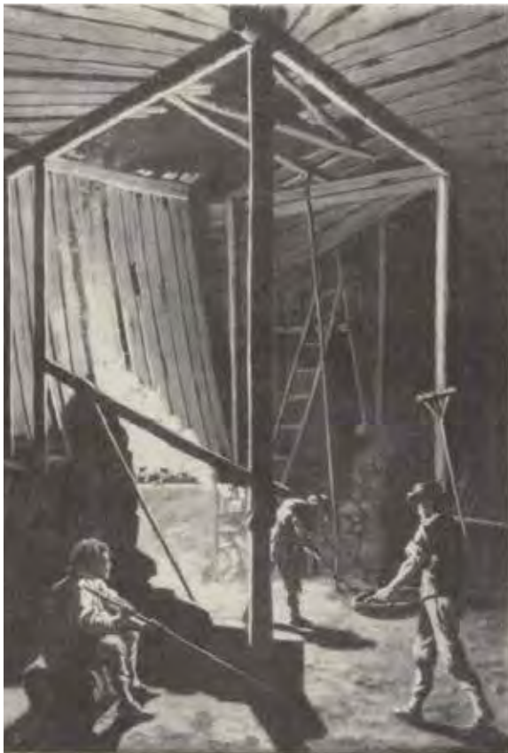
vid Falun 1781. Råkopparsmältning pågår; en smältare med käft på sig till höger, i mitten lyfter en annan en ska till slaggheten, i.v. en rikande smältare med käft på sig. En käftare bär på stöper i.h. — Öjrnäsbruk, 1781.
