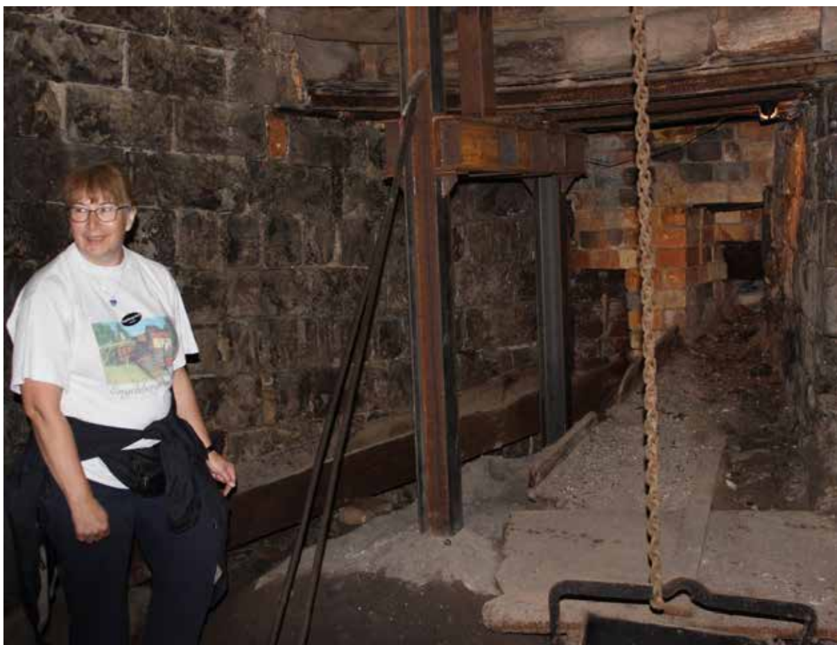
Masugnets tapphål för slagg till böger och för järn strax nedanför till vänster i mynningen bakom Yha.
